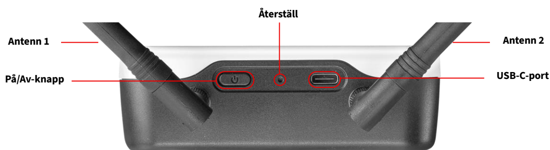
FIGUR 1.6 Baksidan av Bridgemate III server
